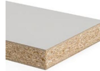
Arbeitsplatte aus einer Holzspanplatte Typ P2 gemäß EN 312, Dekorseite belegt mit Duropal XTreme plus, Unterseite mit wasserabweisendem Ge- genzug. Die Längskanten der Arbeitsplatte sind gefräst. Als Variante ist sie auch einseitig mit einer Schutzkante erhältlich. Duropal XTreme plus ist ein attraktives Supermatt-Oberflächenmaterial mit Anti-Fingerprint-Effekt, wel- ches ideal für horizontal, stark beanspruchte Flächen geeignet ist.
